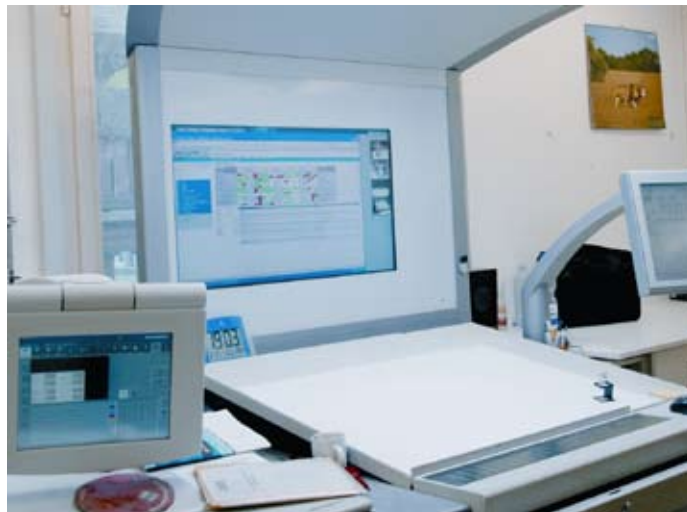
BDE- und Infoterminal sind direkt in den Leitstand integriert.
